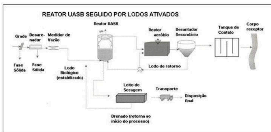
Figura 46: Concepção de ETE típica
